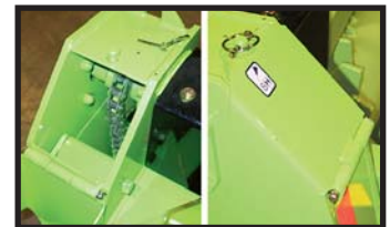
Chaîne d'entraînement entièrement encapsulée
